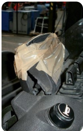
Display pannello strumenti non funzionante o con profonde rigature
