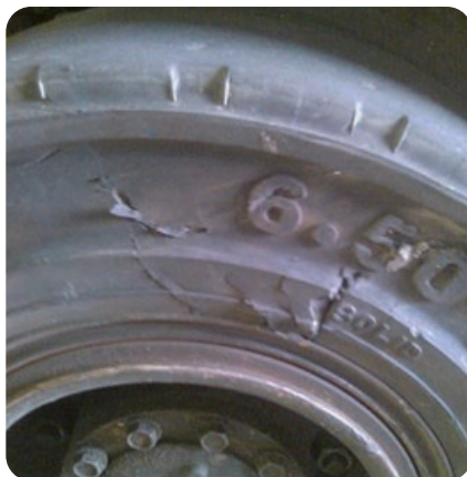
Distacco di pezzi e/o presenza di incisioni
