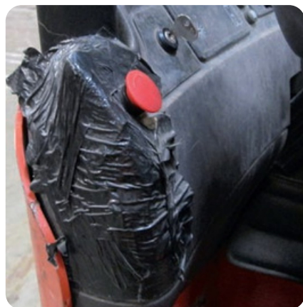
Presenza di rotture
