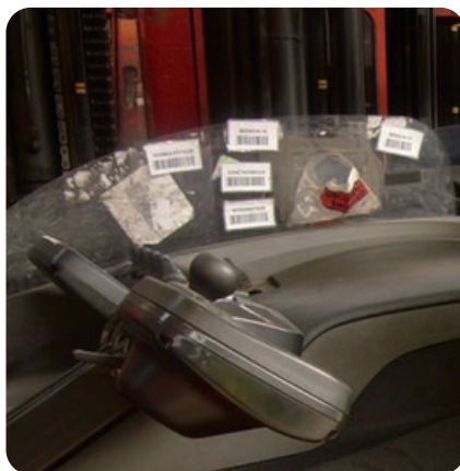
Presenza di adesivi
