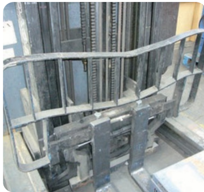
Deformazione di grande entità
